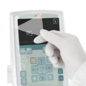
**Покртия.** Практичные одноразовые покрытия защищают стеклянные поверхности панели управления.
