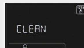
**Очистка.** Функция отключения клавиатуры, если нужно очистить стеклянную поверхность панели, предотвращает нежелательную активацию клавиш.
