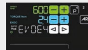
**Endo.** Микромотор i-MMs (опционально) дает стоматологам доступ ко всем функциям эндодонтии, управление которыми осуществляется интегрированным способом с панели на стоматологической установке.
