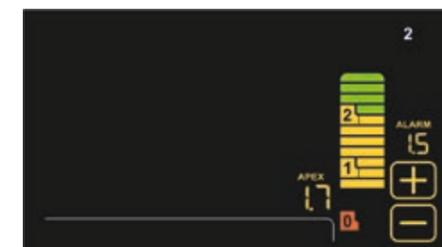
**Апекс-локатор.** Расстояние до апекса выводится на дисплей при инструментальной обработке корневого канала. Приближение апекса проверяется программой ENDO. Как только достигнут апекс, функция Apex-Stop останавливает вращение микромотора.
